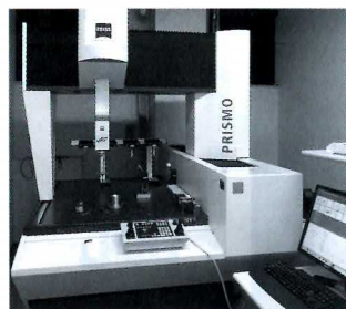
ドイツ・カールツァイス社製の高速CNC3次元座標測定器
